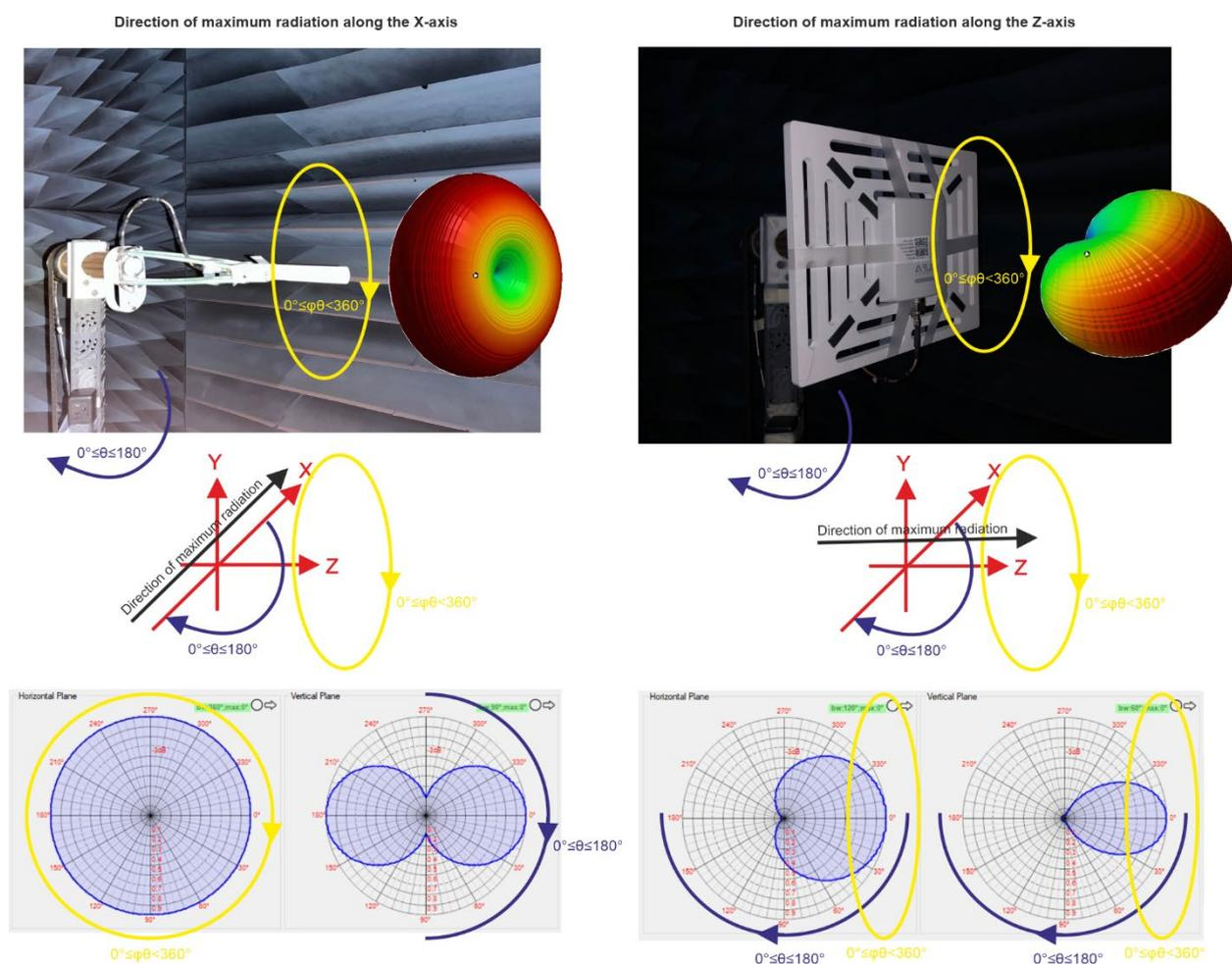
Если при измерениях на стенде антенна располагалась с максимальной излучением по оси Z, то в панели инструментов нужно выбрать  $z^\dagger$ .
